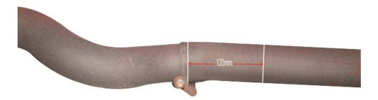
MEASURE FROM THE WELD ON ORIGINAL EX-HAUST 120mm TOWARDS BACK OF CAR, MARK THE PIPE THEN CUT ORIGINAL PIPE, MAKING SURE THE PIPE WORK STAYS SOLIARE
